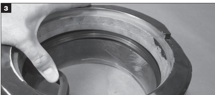
シールをグランドの中央部に向けて押し込みます。力を抜いてシールが自然に溝の中に収まるようにします。
