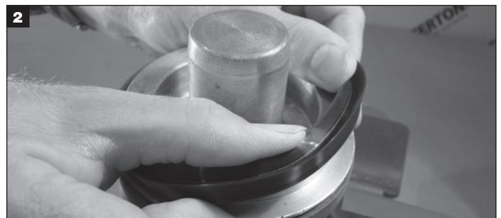
ピストンをしっかり持って、シールを溝の中に配置し、指で押してピストンヘッドの伸ばし広げます。
